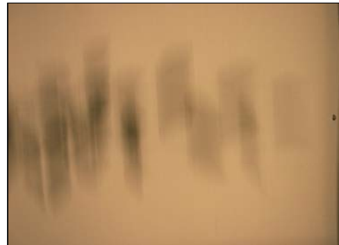
Abb. 12: Senkrechte Schattengrenzen, schräge Schattenverläufe. Die W-förmige Lampe findet man im Schattenbild wieder.
