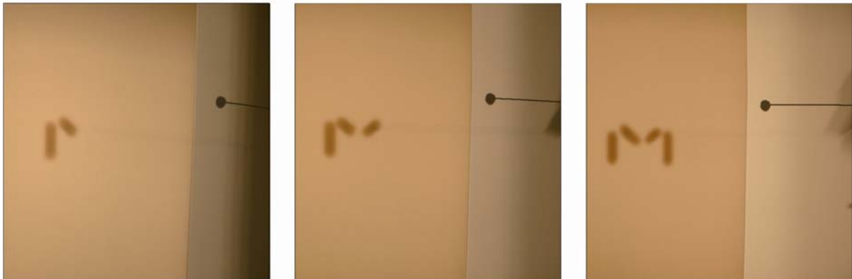
Abb. 8. Während der kreisförmige Schattengeber unverändert bleibt, werden weitere Bereiche der Lampe zugeschaltet. Der Schatten erhält eine M- oder W-förmige Struktur.
